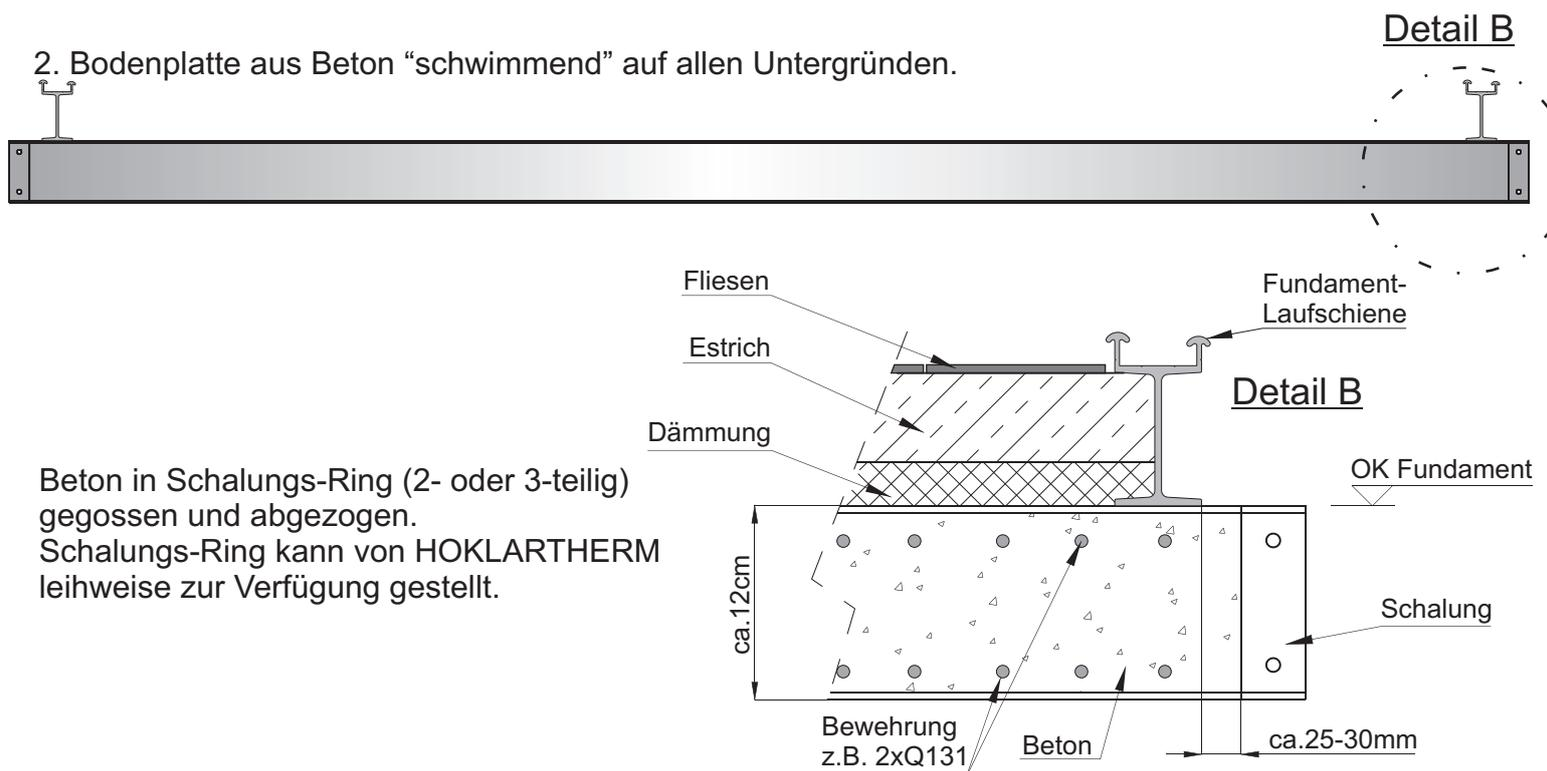
Beton in Schalungs-Ring (2- oder 3-teilig) gegossen und abgezogen.
