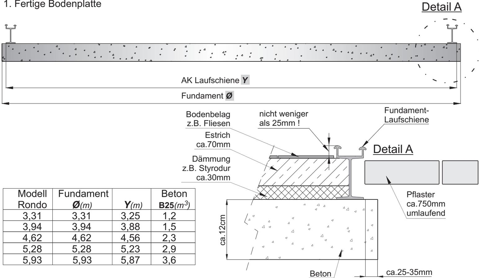
**Auf eine absolut waagerechte Herstellung des Fundamentes ist zu achten, um später ein einwandfreies Verschieben der Elemente zu gewährleisten.**
